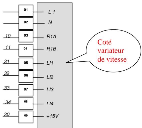
*NB: le convertisseur ATV31 est précablé, on n'aura ainsi aucun câblage au niveau du bornier de commande du convertisseur mais uniquement sur le bornier XVA prévu sur votre platine.*
