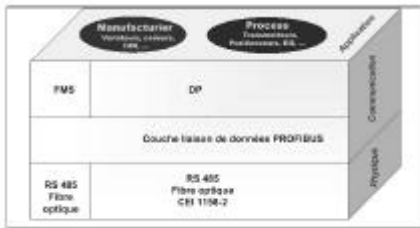
Fig. 3 - Plan d'ensemble de la technologie PROFIBUS
