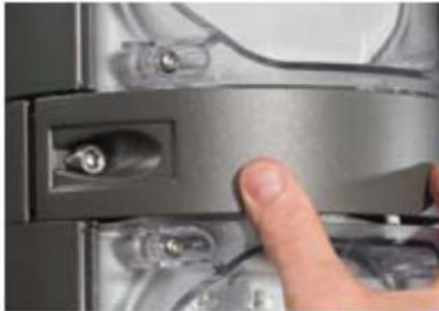
Figure 24 Mise en place de la bride
