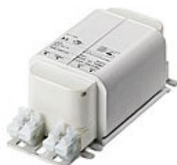
Le ballast conventionnel, du fait de sa puissance (d'environ 12 Watts), représente en moyenne 12% de la consommation de la lampe avec un facteur de puissance de l'ordre de 0,5 (ce qui, dans le cas d'un poste d'alimentation en tarif vert, est pénalisé sur la facture d'électricité).
