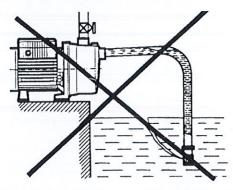
Si l'électropompe travaille en charge, le clapet de pied est remplacé par une vanne d'isolement de la pompe.
