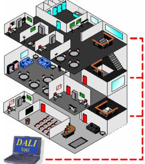
Dans une configuration d'un bâtiment à plusieurs étages, les passerelles DALI offrent la possibilité de gérer des ambiances lumineuses, des plages horaires, des séquences en fonction des occupations de salle. Associé à une supervision, le système peut connaître l'état des lampes programmer ses opérations de maintenance des équipements sans avoir à se déplacer pour vérifier l'état des lampes
