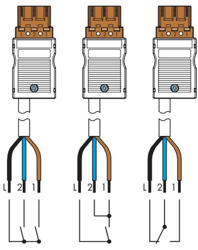
Cordons interrupteur/va et vent précablés avec codage S pour le raccordement d'un distributeur, référence 770-637 et 770-638, voir page 40.
