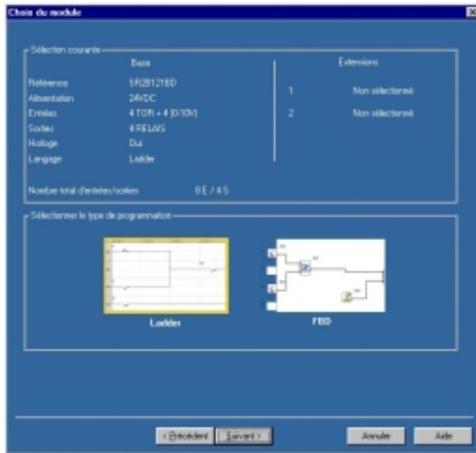
Par défaut, le langage à contact (ladder) est sélectionné (encadré jaune), cliquez sur **Suivant** pour programmer en ladder. Cliquez sur l'icône FBD puis sur **Suivant** pour programmer en FBD.
