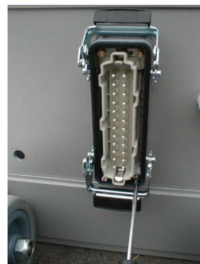
4 – Connexion du cordon au deux extrémités, des détrompeurs permet d'éliminer tout erreur de mise en place
