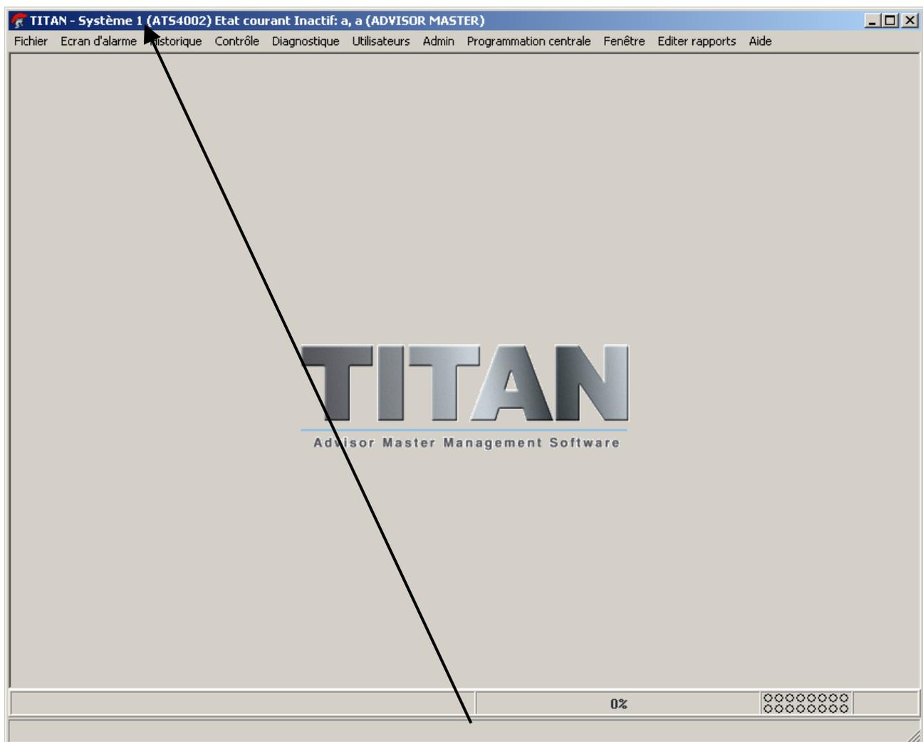
TITAN se lance automatiquement sur le '**système 1**' par défaut. Le '**système 1**' correspond à une configuration type d'une centrale ATS. Il est recommandé de ne pas y toucher et de créer par '**clonage**' un **système 2** sur lequel on travaillera.
