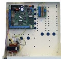
Centrale d'alarme NFA2P type 3 N° 123020-00
